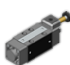
pilotventil 5/2-cestný ventil ISO 1, elektro-pneumatický, G1/4, p = 4 - 10bar
