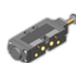
pilotventil 5/2-cestný ventil co-ax, elektro-pneumatický, G1/4, p = 4 - 10bar
