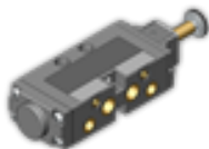
Pilotventil 5/2-Wege Ventil co-ax, elektropneumatisch, G1/8, p = 4 - 10bar
