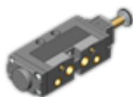
vezérlőszelep 5/2-es szelep co-ax, elektropneumatikus, G1/8, p = 4 - 10bar
